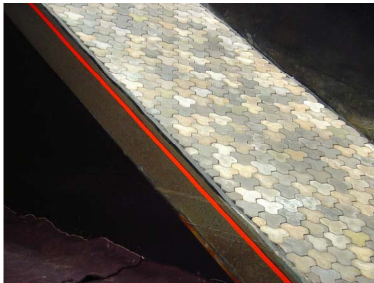
Figura 2.- Revestimiento Betonplan previo a un ensayo
