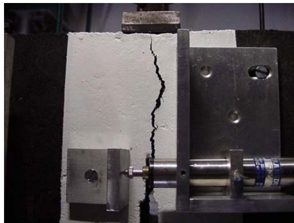
Figura 1 - Propagação típica das trincas de reflexão nas vigas sem geogrelha. Carga na posição de flexão.
