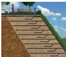
Muros de suelo reforzado
